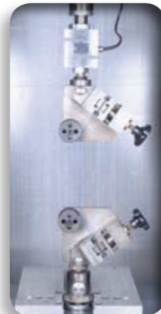
EN Maximum load and hysteresis test. IT Test per la misura di carico e d'isteresi. FR Test pour la résistance et l'hystérésis. ES Test para la medida de carga y stress.
